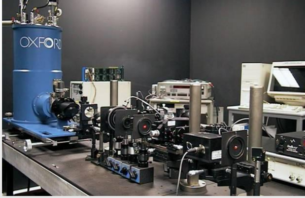
Birincil Seviye Krayojenik Radyometre
