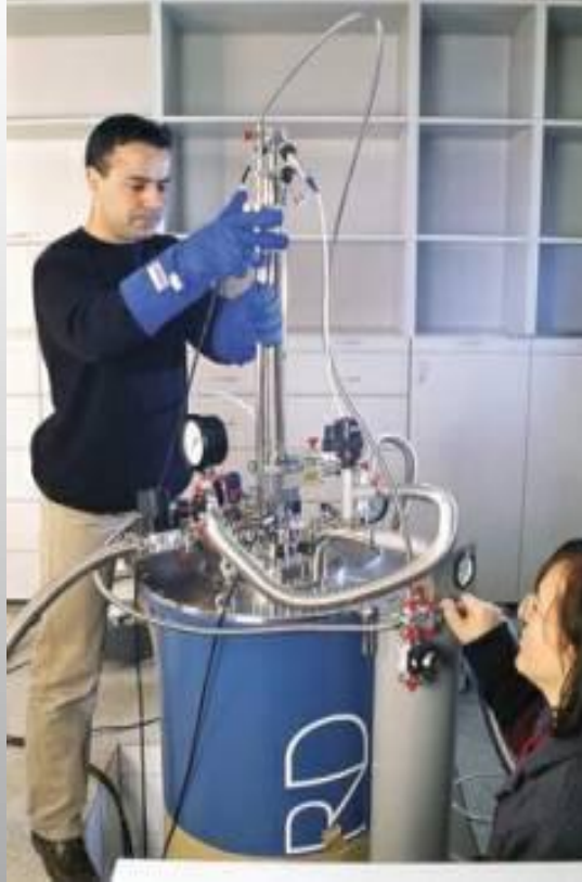
Birinci seviye Quantum-Hall sistemi DC direnç birimi
