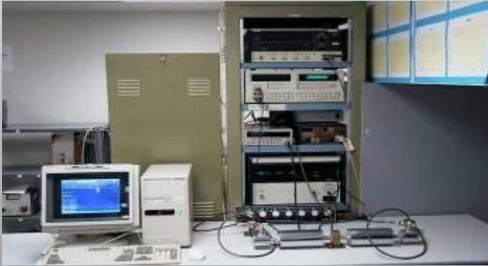
AC-DC Gerilim Transfer Standartları
